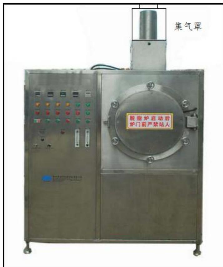
图 4-2 脱脂炉集气罩示意图
